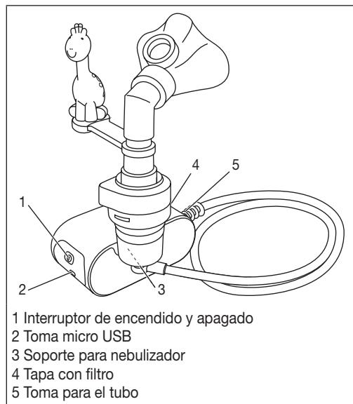
1 Interruptor de encendido y apagado
