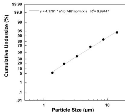
Ölçümler bir “Next Generation Impactor” (NGI) ile ve sodyum florür çözeltisi kullanılarak yapılmıştır. Diyagram bu nedenle süspansiyonlar veya çok koyu kıvamlı ilaçlar için geçerli olmayabilir. Bununla ilgili ayrıntılı bilgileri ilgili ilaç üreticisinden alabilirsiniz.
