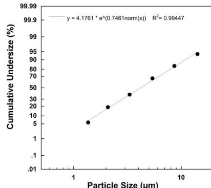
Les mesures ont été effectuées avec une solution de fluorure de sodium à l'aide d'un impacteur NGL (Next Generation Impactor).
