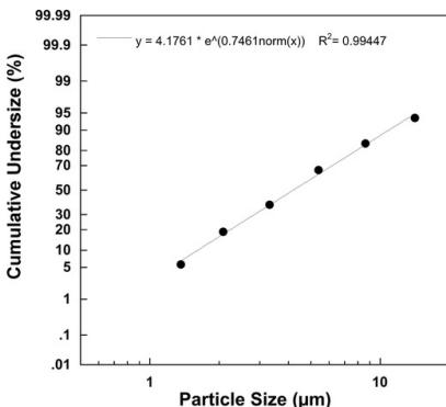
Измерения производились с использованием раствора фторида натрия при помощи импактора нового поколения «Next Generation Impactor» (NGI). Поэтому диаграмма может быть неприменима для суспензий или очень густых лекарственных препаратов. Подробную информацию можно получить у производителя соответствующего лекарственного препарата.
